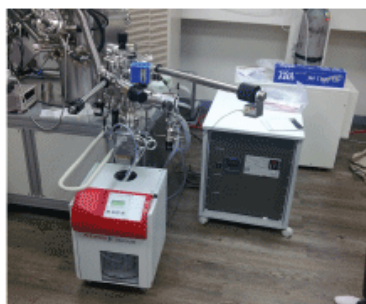
图9 – 安装在样品导入室上的超高真空预抽与气体反应室。除可对样品作加热冷却之外，也可以加入气体反应。
